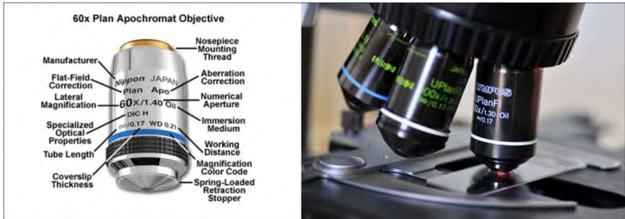
Figura 21. Inscripcions i codis que pot incorporar un objectiu de microscopi (esquerra) i detall dels objectius utilitzats al Departament de Microbiologia de la Facultat de Biologia (dreta). Imatge esquerra extreta de: http://www.olympusmicro.com/primer/anatomy/specifications.html .
