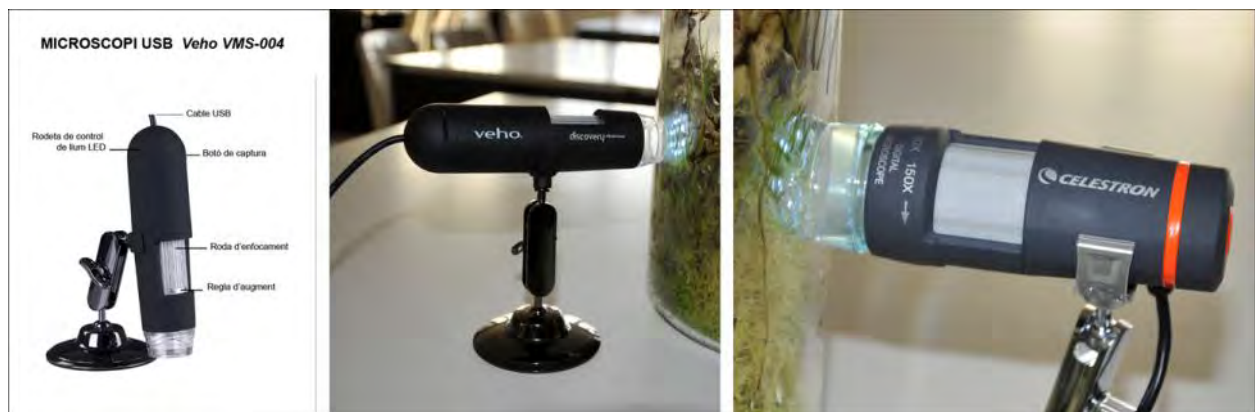
Figura 9. Dibuix explicatiu (esquerra) de les parts del microscopi Veho (centre) i detall del Celestron (dreta). Aquest últim no disposa de rodeta de control de llum LED (sempre està encesa a la mateixa intensitat).
