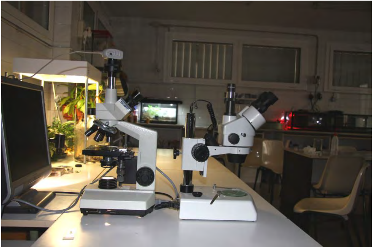
Figura 18. Per diferenciar externament un microscopi òptic (esquerra) d'una lupa binocular (dreta) ens hem de fixar amb la platina mòbil (amb un forat central) i el revòlver amb 4 o 5 objectius, ambdós exclusius del microscopi òptic; per la seva part, la lupa binocular utilitza dos oculars i dos objectius alhora que li confereix característiques estereoscòpiques úniques. (En la imatge també es pot observar una càmera acoblada al tercer ocular del MO). (Figura extreta del treball de recerca d'Ariadna Simón)
